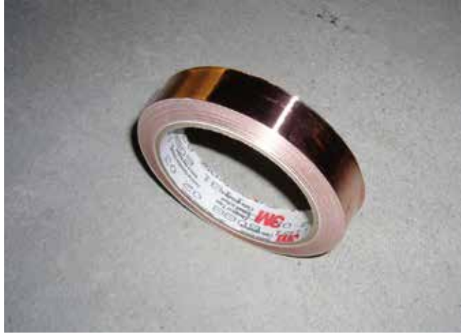
2 Szalag (öntapadó) a vezetőképes burkolat kialakításához.
