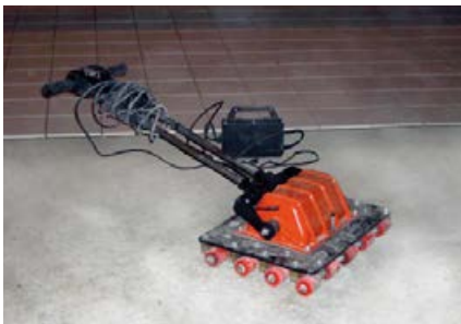
Oberflächenrüttler zum Einrütteln von keramischen Belägen.
