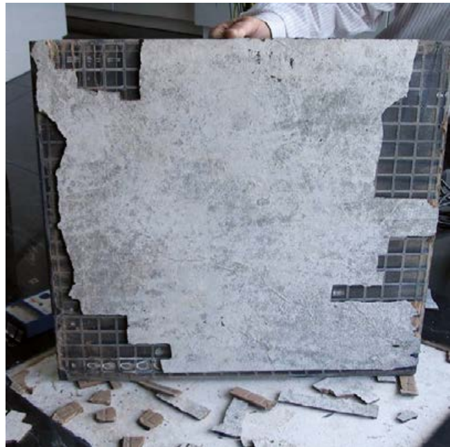
Haftverbundschäden auf einem calciumsulfatgebundenen Estrich aufgrund eingeschlossener Feuchtigkeit.
