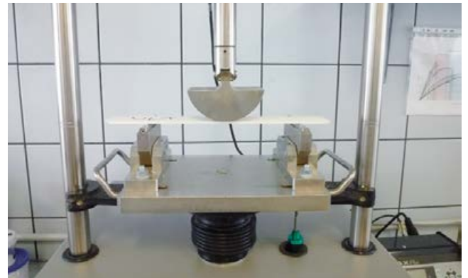
Prüfanordnung für die S1/S2-Prüfung.
