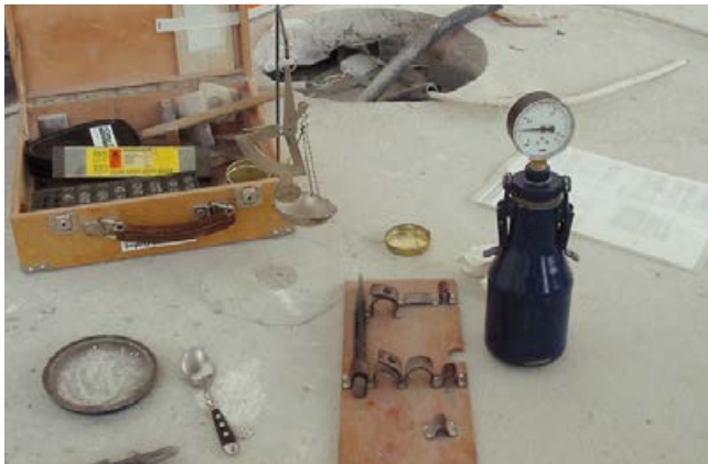
CM-Messung zur Bestimmung der Restfeuchte in Estrichen.
