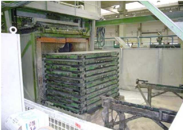
Formen zur Herstellung von Betonwerksteinplatten.
