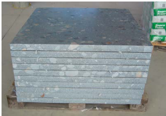
Betonwerksteinplatten nach dem Gatterprozess. Gut ist die große Zuschlagskörnung erkennbar.
