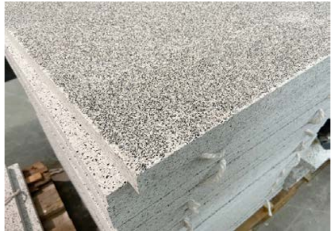
Rückseitige Abspernung der Platte mit Quarzsandabspernung.
