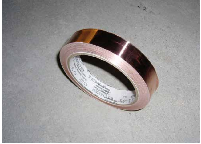
2 Kupferband (selbstklebend) zum Anlegen eines leitfähigen Belages.
