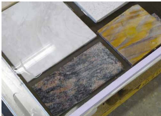
Versuch: Nach einer gewissen Zeit zeigen die aufgelegten Natursteinplatten Verdunkelungen.
