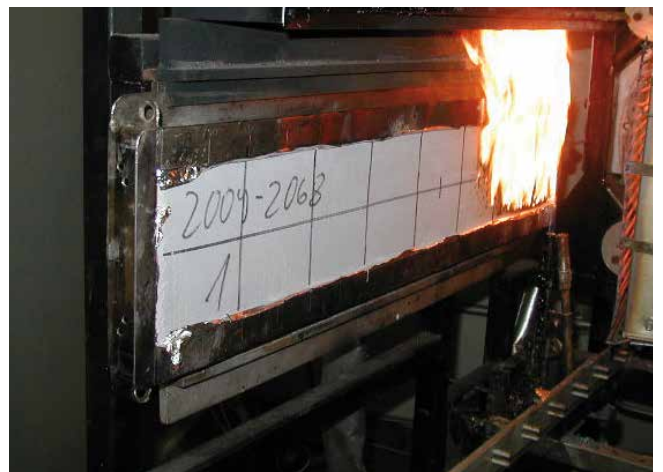
Prüfung eines Probekörpers im Brandhaus.
