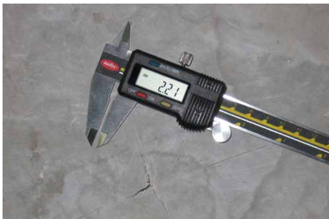
Schieblehre zum Messen der Schichtdicke.
