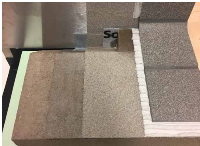
Anschluss mit Hohlkehlsattel an der Kühlzelle.
