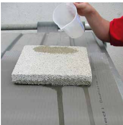
Leichter Wasserabfluss in einer Drainageestrich-Musterplatte.
