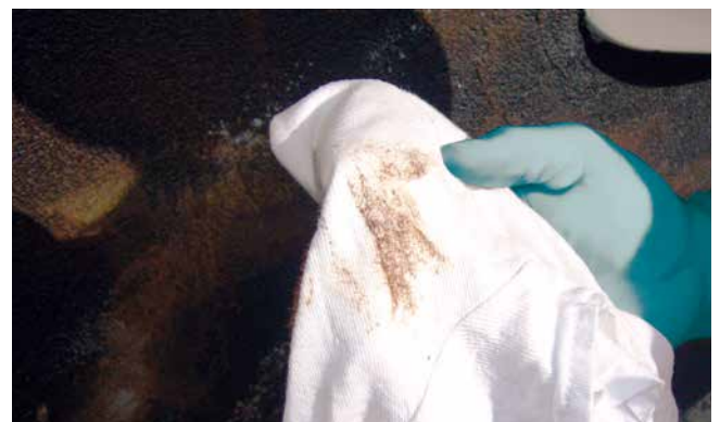
Braunfärbung: Die Fläche lässt sich anlösen. Es handelt sich mit sehr hoher Sicherheit um einen Bitumenanstrich.
