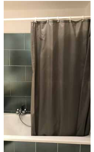
Da der Spritzwasserschutz nicht verhindern kann, dass trotzdem Wasser auf den Boden gelangt, ist der Boden in W1-I einzustufen.
