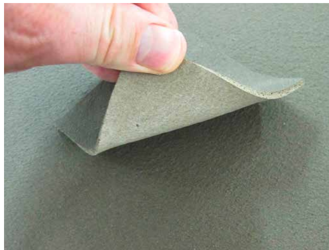
Die Schichtdicke der Abdichtung ist entscheidend für deren Qualität.
