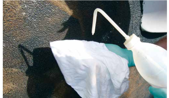
Wischprüfung mit weißem Tuch und Benzin.
