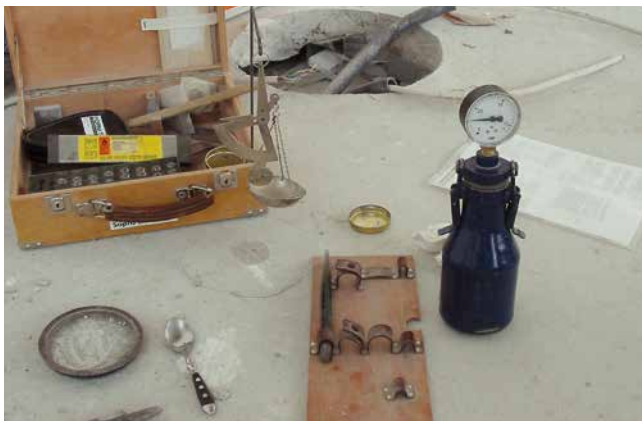
CM-Messung zur Bestimmung der Restfeuchte in Estrichen.
