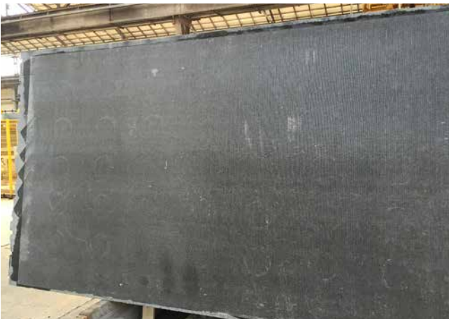
Rückseitig mit Harz und Gewebeeinlage behandelte Platte.
