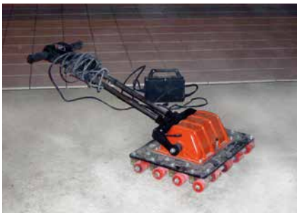
Oberflächenrüttler zum Einrütteln von keramischen Belägen.
