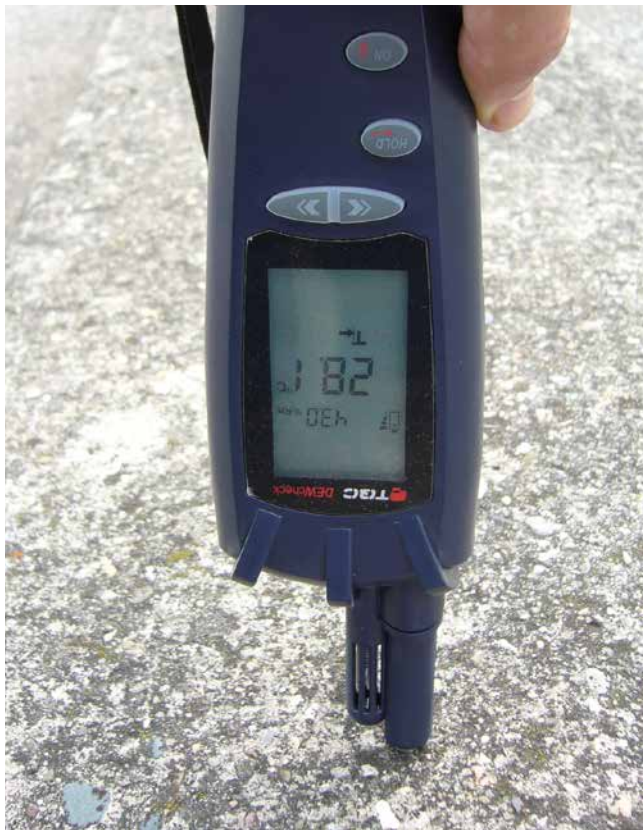
Messung der Bauteiltemperatur.
