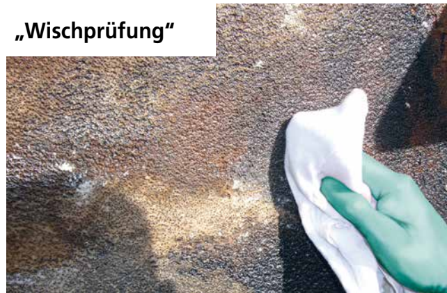
Wischprüfung mit weißem Tuch und Benzin.
