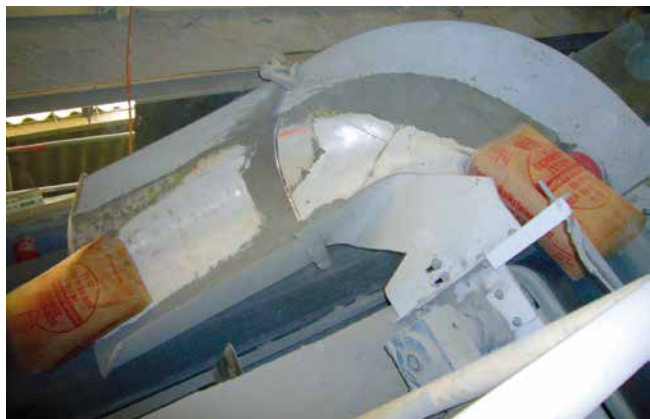
Verformung des Bodens einer Aufzugskabine nach oben bei Entlastung der Bodenfläche durch Abwärtsfahrt.
