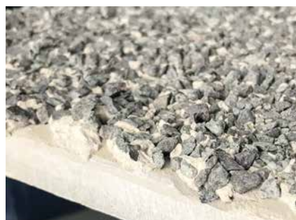
Gut sind die eingebundenen Splittkörner auf der Rückseite erkennbar.
