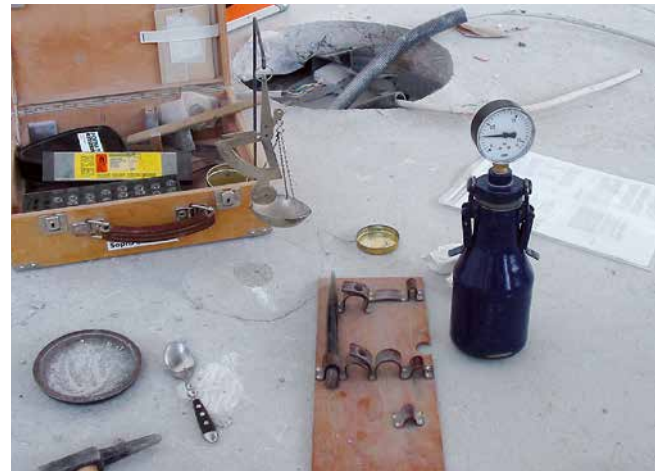
Restfeuchtebestimmung des Estrichs mit dem CM-Gerät. Probenentnahme erfolgt über den gesamten Querschnitt des Estrichs.
