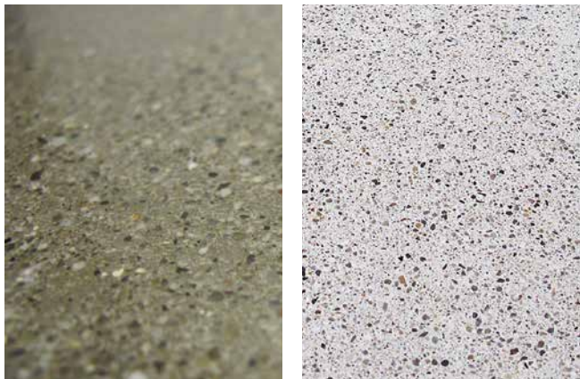
Durch das Schleifen und Polieren entsteht eine geschlossene, optisch ansprechende Terrazzo-Oberfläche. Diese ist in zwei Farben herstellbar – grau und weiß.
