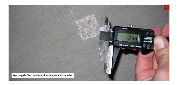
Fläche (bspw. Großküche, Beckenumgang, etc.) so ist mindestens eine Messung pro 100 m² durchzuführen. Soll jedoch die Schichtdicke einer Abdichtung von kleineren zusammenhängenden Flächen bis 20 m² (bspw. Badezimmer) geprüft werden, so sind dabei mindestens 5 Einzelmessungen durchzuführen.
