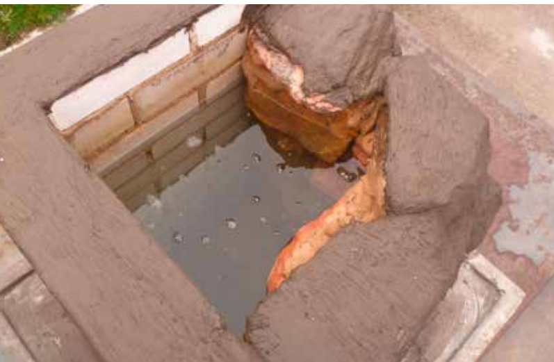
Erzeugen eines rückseitigen Wasserdrucks auf die Negativabdichtung
