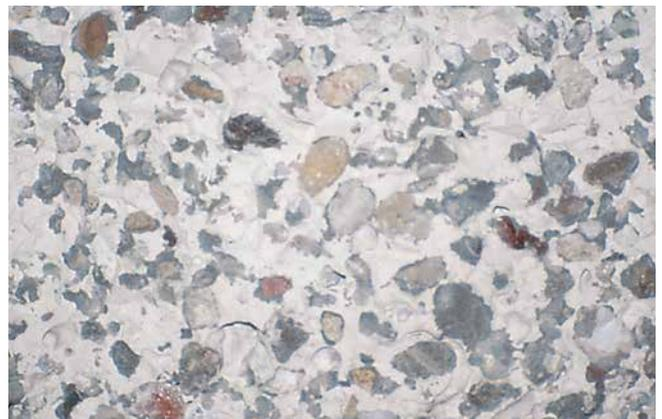
Dichtes Gefüge nach Einsatz von Soprodur® MicroHohlraumSchlämme.
