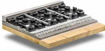
Aufbau des Dünnschichtsystems auf einem Holzuntergrund mit 4 mm Dämmplatte und Fließspachtel; Aufbauhöhe mindestens 23 mm.
