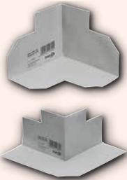
Innovative, chemisch- und mechanisch hoch beanspruchbare Premium-Dichtecken ohne äußere Vliesbeschichtung zur dauerhaften Abdichtung von Innenecken in Kombination mit Sopro AEB® Abdichtungs- und Entkopplungsbahn HD unterhalb keramischer Fliesen und Platten sowie von Naturwerksteinfliesen.
