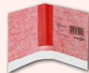
Flexible, selbstklebende, beidseitig mit einem speziellen Vliesgewebe beschichtete Wannendichtecke aus hochwertigem Polypropylen. Zur wasserdichten Anbindung von Dusch- und Badewannen an die Flächenabdichtung. Normkonform gemäß DIN 18534, keine Abdichtung hinter oder unter der Dusch- oder Badewanne notwendig.
