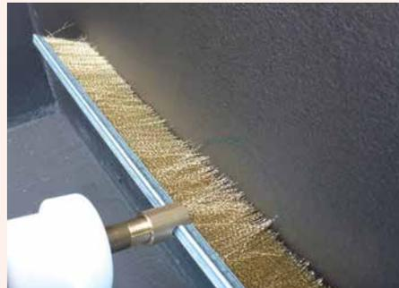
**2** Auf Poren, Löcher, Risse oder Fehlstellen wird mittels einer Funkenentladung und einem akustischem Signalton hingewiesen.
