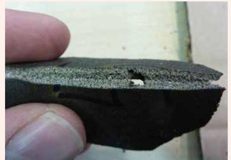
**3** Trotz eines mehrschichtigen Auftrags der Abdichtung können kleine Fehlstellen und Schwankungen der Schichtdicke auftreten, die durch bloße Betrachtung häufig schwer zu erkennen sind.
