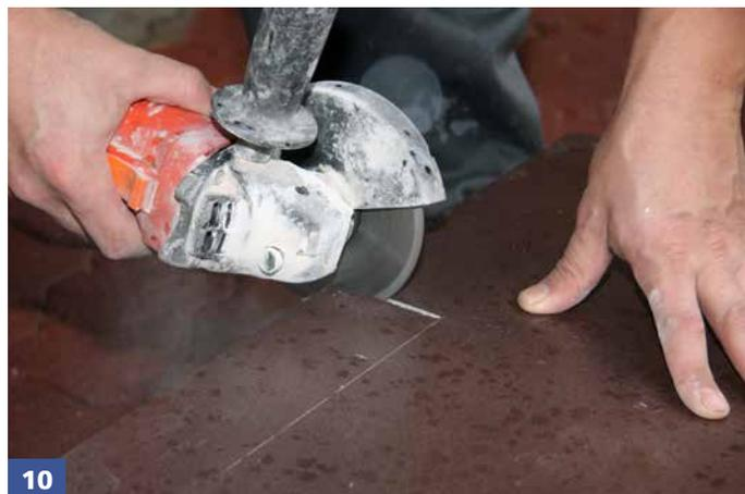
10 Alternativ mittels Winkelschleifer zuschneiden.
