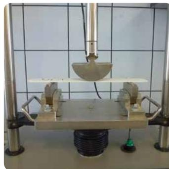
Prüfanordnung für die S1/S2-Prüfung gemäß DIN EN 12004
