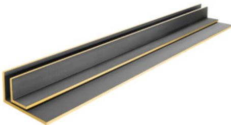
Hochwertige, äußerst formstabile 90°-Winkelemente aus einem wasserdichten, extrudierten Polystyrol-Hartschaum (XPS) Trägerelement, beidseitig mit einer mineralischen Spezialbeschichtung und Glasfasergewebe verarbeitet. Konstruktives Element für den Innenausbau, insbesondere bei Feuchtraumanwendungen. Abdichtung im Verbund mit Fliesen- und Plattenbelägen nach DIN 18534.
