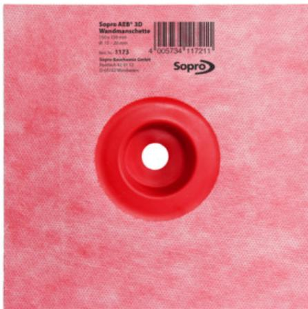
**Innovative, dreidimensionale, beidseitig mit einem speziellen Vliesgewebe beschichtete Spezial-Wandmanschette zum sicheren Abdichten von nicht aus der Wand herausragenden Rohrdurchführungen. Die Spezial-Wandmanschette verlagert die Abdichtungsebene in die Wand hinein. Für die Abdichtung mit flüssig zu verarbeitenden Verbundabdichtungen und bahnenförmigen Sopro Verbundabdichtungen.**
