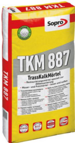
Hydraulischer Trockenfertigmörtel mit Trass, Putzmörtel nach ÖNORM EN 998-1, GP, CS II, Wc0, Mauermörtel nach ÖNORM EN 998-2, M 2,5, Restaurierungsmörtel speziell zur Althausanierung.
