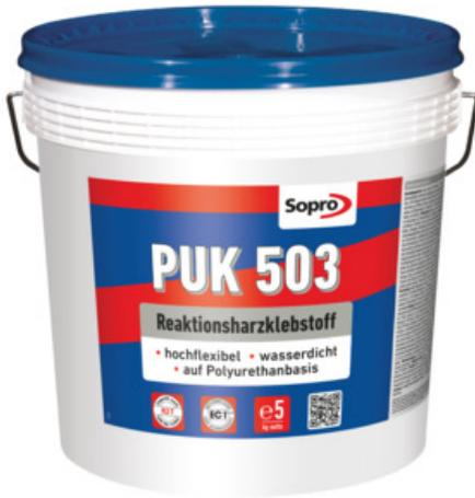
Zweikomponentiger, weißer Polyurethan-Reaktionsharz-Klebstoff, R2 T nach DIN EN 12004, zum Ansetzen und Verlegen von keramischen Fliesen und Platten, Beton- und Naturwerksteinplatten, kunstharzgebundenen Platten und Glasmosaik, besonders auf Holz- und Gipsbaustoffen sowie Metallen. Geeignet auf Wand- und Fußbodenheizungen. Für erhöhte Anforderungen an Haftzugfestigkeit und Haftscherfestigkeit, Elastizität und Wasserdichtigkeit auf kritischen Untergründen.
