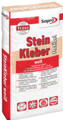
Weißer, schnell erhärtender, zementärer, flexibler, trasshaltiger Mittelbettmörtel. C2FT in Anlehnung an EN 12004, für Mörtelbettdicken von 5 - 20 mm. Zum Verlegen von Pflastersteinen und Pflasterplatten aus Beton- oder Naturwerksteinen.
