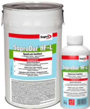
Zweikomponentige Epoxidharz-Schutzbeschichtung auf Basis eines speziellen, pigmentierten Bauharzsystems. Zum Schutz von zementgebundenen Untergründen, wie z. B. Estrich- und Betonflächen sowie mit Sopro Fließspachtel hochfest hergestellten direkt nutzbaren Flächen gegen mechanische und chemische Belastungen. Erhärtet zu einer wasserdampfdurchlässigen Oberflächenschutzschicht. Daher auch als Nachbehandlungsmaßnahme für junge Estriche geeignet.
