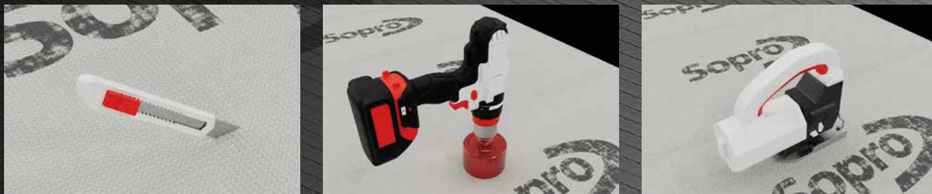
Sopro Boards können mit einem Cuttermesser, einer Kreissäge mit Führungsschiene oder einer Stichsäge auf die passende Form zugeschnitten bzw. bearbeitet werden. Aussparungen für eventuell vorhandene Anschlüsse können z. B. mit einem Bohrkranz ausgeführt werden.
