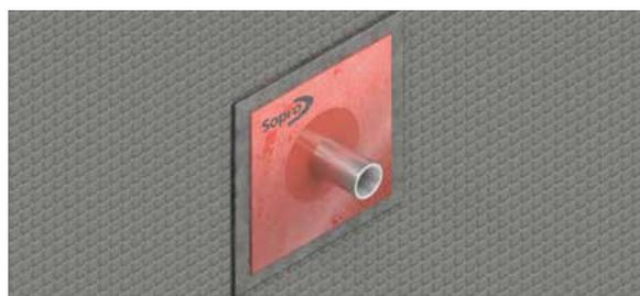
Rohrdurchführungen sind mit Sopro AEB® Wandmanschetten abzudichten. Die flexible Dehnzone der Manschette wird über die Durchdringung gestülpt und vollflächig mit einem im System geprüften Stoßkleber auf dem Sopro Board wasserdicht verklebt.
