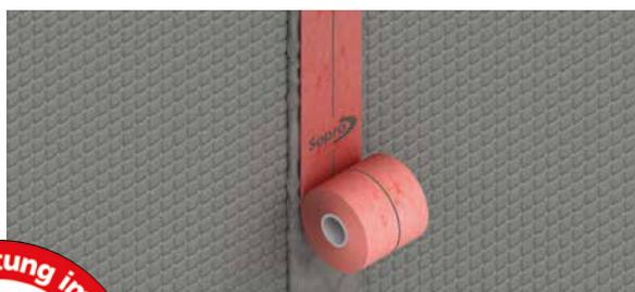
In der Wassereinwirkungsklasse W2-I sind die Stöße zusätzlich mit Sopro AEB® Dichtbändern zu überarbeiten. Dabei muss das Dichtband hinterläufiger an den plattenförmigen Abdichtungsstoff angeschlossen werden.
