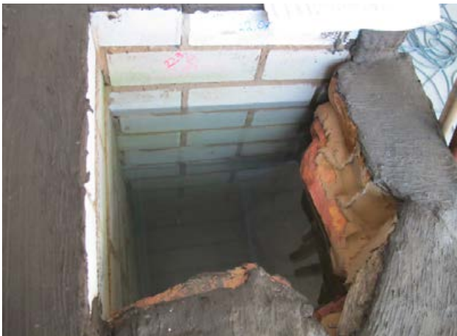
Versuch: Dichtschlämme mit permanent anstehenden negativem Wasserdruck.
