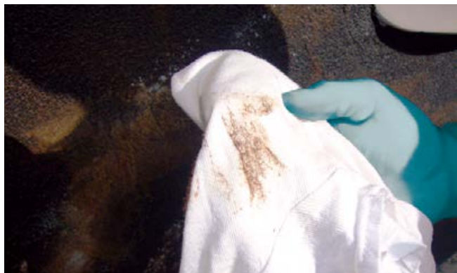
Braunfärbung: Die Fläche lässt sich anlösen. Es handelt sich mit sehr hoher Sicherheit um einen Bitumenanstrich.
