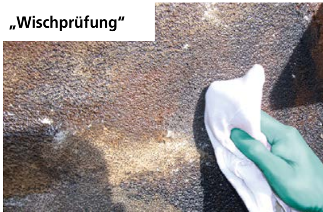
Wischprüfung mit weißem Tuch und Benzin.
