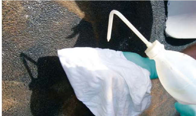
Wischprüfung mit weißem Tuch und Benzin.
