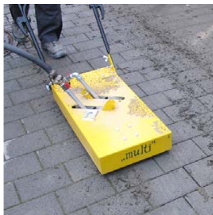
Reinigung mittels Hochdruckreiniger oder mit einem pressluftbetriebenen Spezialwerkzeug.
