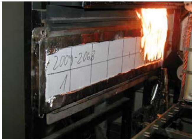
Prüfung eines Probekörpers im Brandhaus.
