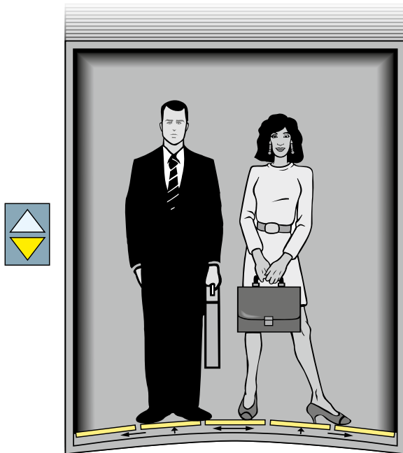
Verformung des Bodens einer Aufzugskabine nach oben bei Entlastung der Bodenfläche durch Abwärtsfahrt.
