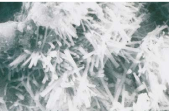
Ettringitbildung bei normalem Dünnbettmörtel in der Grenzflächenzone zum Calciumsulfatestrich (Anhydritestrich).
