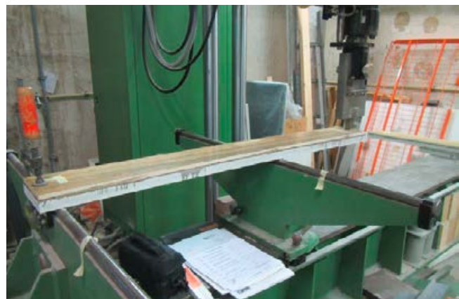
Versuchsaufbau im Labor – Verformungsaufnahme mit Belag.
