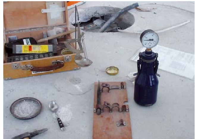
Restfeuchtebestimmung des Estrichs mit dem CM-Gerät. Die Probenentnahme erfolgt über den gesamten Querschnitt des Estrichs.
