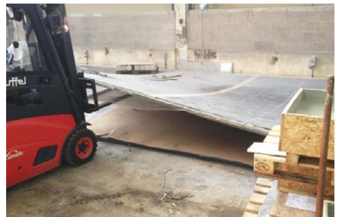
Selbst „extreme“ Verformungen zeigen keinen Haftverbundschaden oder Risse im System dank des S2-Klebers.
