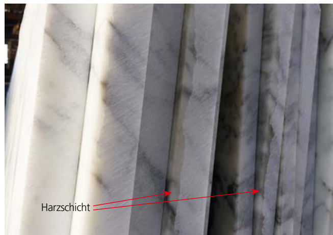
Mit Harz in der Oberfläche behandelte Platten.
