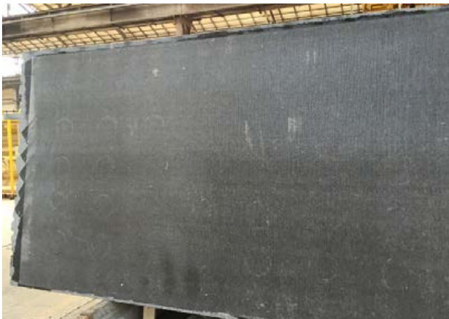
Rückseitig mit Harz und Gewebeeinlage behandelte Platte.
