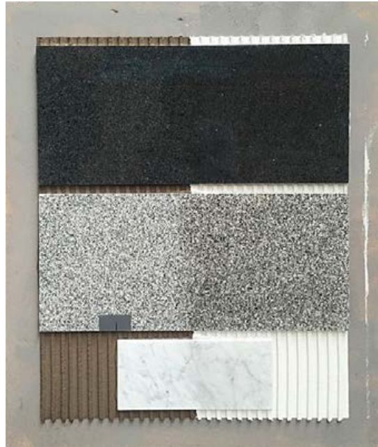
Versuch mit grauem und weißem Mörtel. Auch weiße Mörtel können zu Verfärbungen führen, solange sie nicht schnell erhärtend sind.
