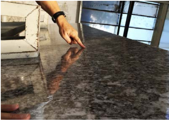
Mit Harz behandelte Oberflächen, um Risse und Gefügestörungen kosmetisch zu reparieren.
