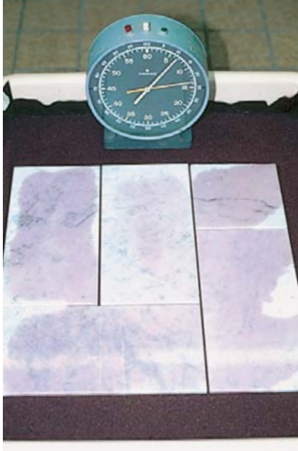
Verlegung eines hellen Naturwerksteins im Dickbettmörtel. Eine schnelle Durchfeuchtung mit entsprechenden Verfärbungen können die Folge sein.
