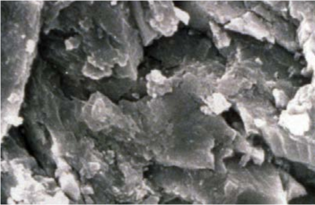
Rasterelektronenmikroskopaufnahme einer Naturwerksteinplatte: Die große Zerklüftung lässt erkennen, dass Naturwerksteine zu einer starken Wasseraufnahme neigen können.
