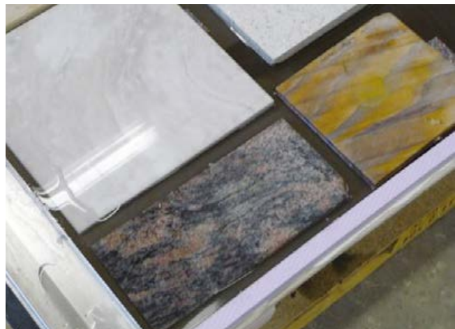
Versuch: Nach einer gewissen Zeit zeigen die aufgelegten Naturwerksteinplatten Verdunkelungen.
