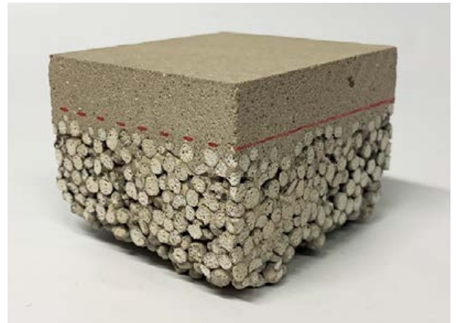
VarioFließspachtel plus Armierungsgewebe im Verbund mit dem Leichtzuschlag.
