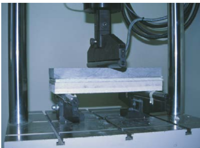
Versuchsanordnung zur Prüfung der Durchbiegung und maximalen Lastaufnahme eines entkoppelten Systems.
