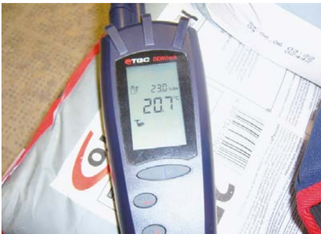
Messung der Lufttemperatur und der relativen Luftfeuchte.
