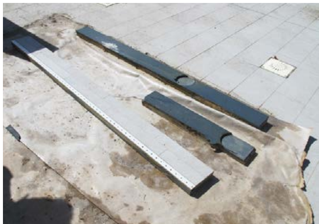
Sehr dickschichtige Kunststoffeinbauteile verformen sich leicht und werden länger, bzw. kürzer unter Temperatureinfluss.
