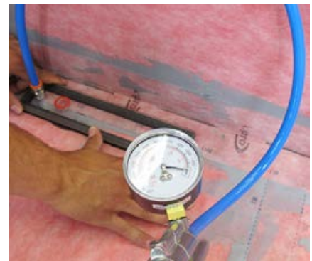
Alternativ mit der Unterdruckpumpe: Die Prüfschablone wird aufgelegt. Lässt sich ein Unterdruck (Vacuum) aufbauen, so ist der Stoß dicht. Wenn nicht, so ist eine Undichtigkeit gegeben, welche zu überarbeiten ist.
