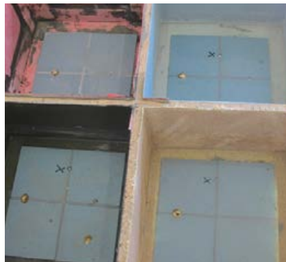
Prüfkiste mit verschiedenen Verbundabdichtungssystemen.
