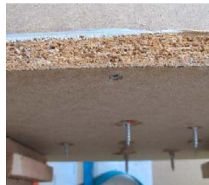
Boden der Prüfkiste 28 Tage Druckprüfung – Dicht!
