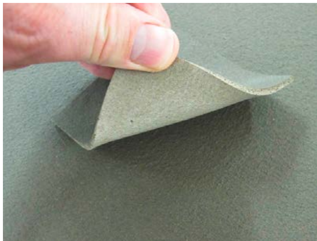
Die Schichtdicke der Abdichtung ist entscheidend für deren Qualität.
