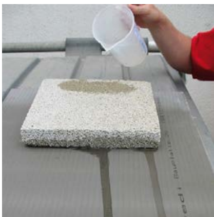
Leichter Wasserabfluss in einer Drainageestrich-Musterplatte.
