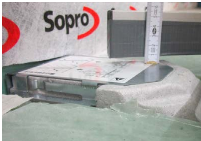
2 Die Estrichüberdeckungen sind partiell sehr dünn.
