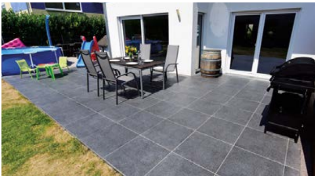
Großformatige, 2 cm-starke, keramische Outdoorplatten zur ansprechenden Gestaltung von Terrassen auf Splittbett.
